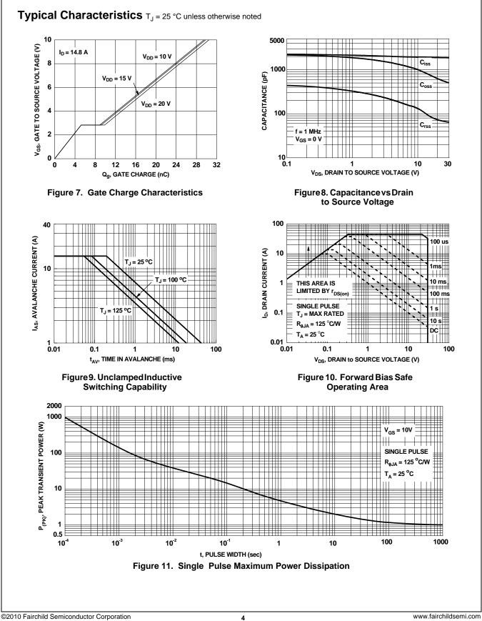
FDMC7672S N-Channel Power Trench<sup>®</sup> SyncFET<sup>TM</sup>
